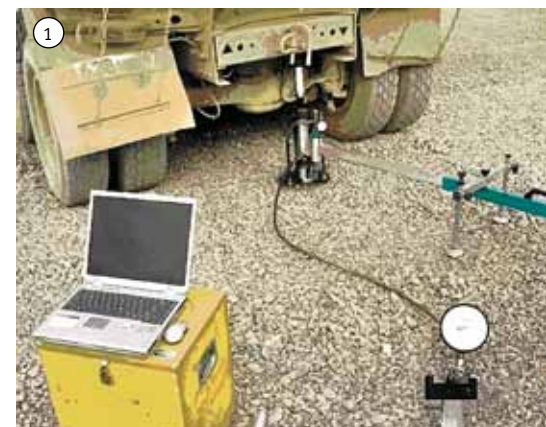
Испытание подстилающего слоя поверхностным штампом
